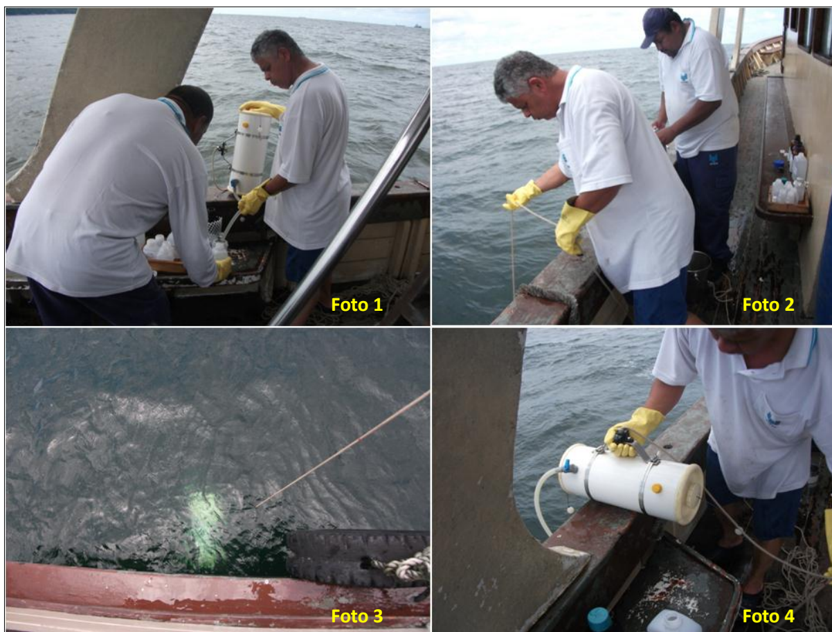
Fotografias 1, 2, 3 e 4 – Campanha de amostragem em 23/02/2011 na Baía de Santos, coleta realizada com garrafa Van Dorn em diferentes profundidades (Fotos do Autor).
