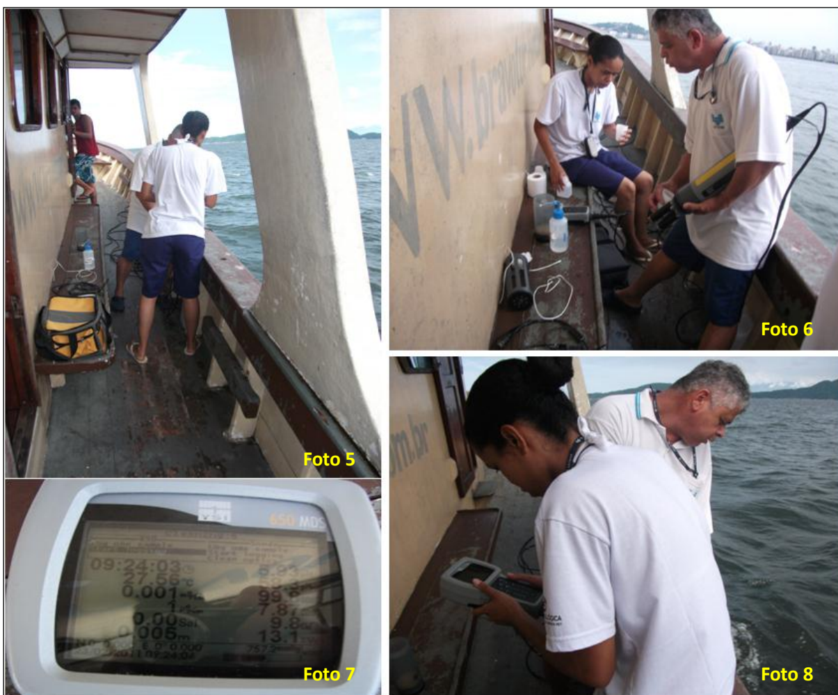
Fotografias 5, 6, 7 e 8 – Campanha de amostragem em 23/02/2011 na Baía de Santos, análise com a sonda multiparâmetros ( Fotos do Autor).
