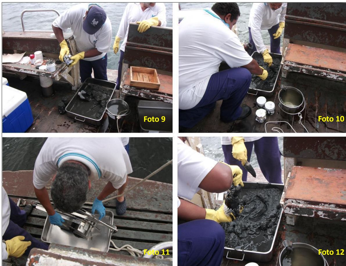
Fotografias 9, 10, 11 e 12 – Campanha de amostragem em 23/02/2011 na Baía de Santos, coleta do sedimento realizada com Pegador de Petersen (Fotos do Autor).
