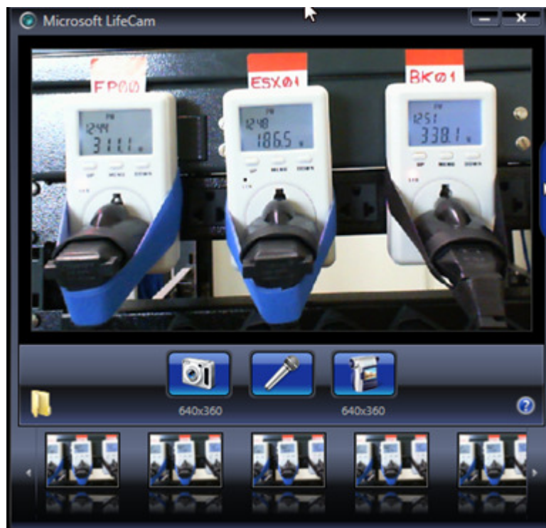
Figura 5 – Registros de medições instantâneas de vários instrumentos através da webcam
