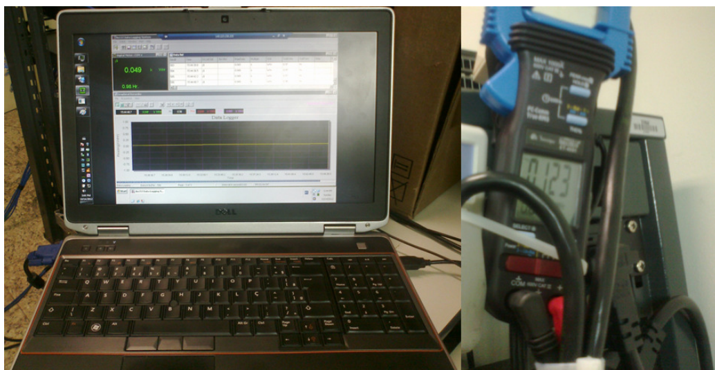
Figura 3 – Alicate amperímetro fornecendo dados para software de coleta
