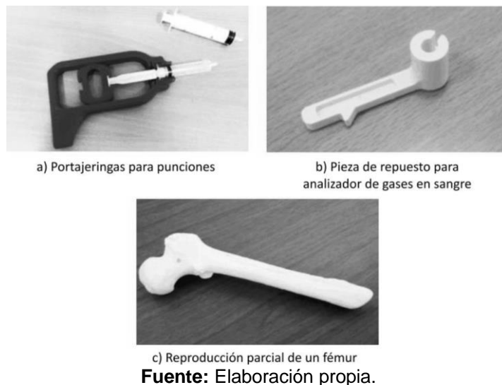
Figura 4: Ejemplos de dispositivos, partes y componentes biomédicos fabricados con tecnologías digitales tridimensionales.
