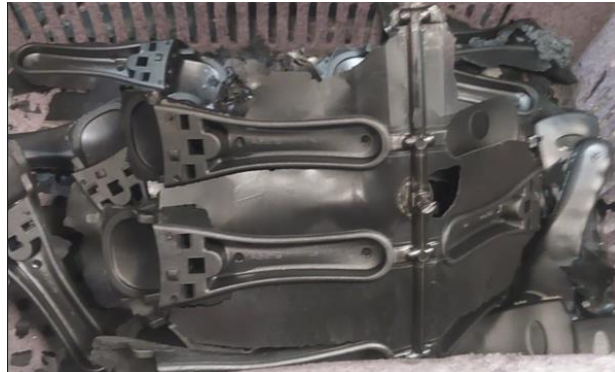
Figura 6 – Peças injetadas com pressão muito alta
