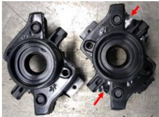
Figura 12 – Peça com desvio dimensional
