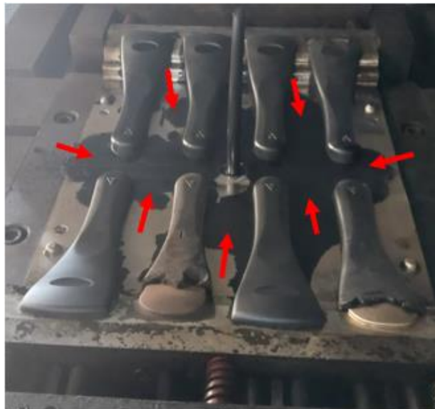
Figura 7 – Molde com resíduos de termofixo
