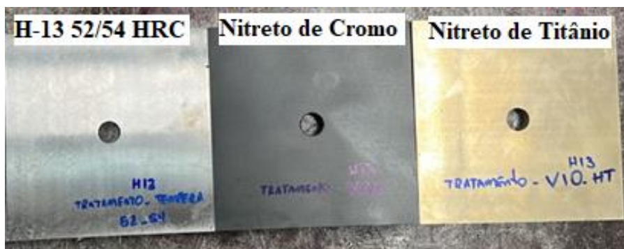
Figura 4 Aço AISI H-13 com dupla camada de PVD
