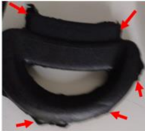
Figura 11 – Peça com excesso de rebarbas
