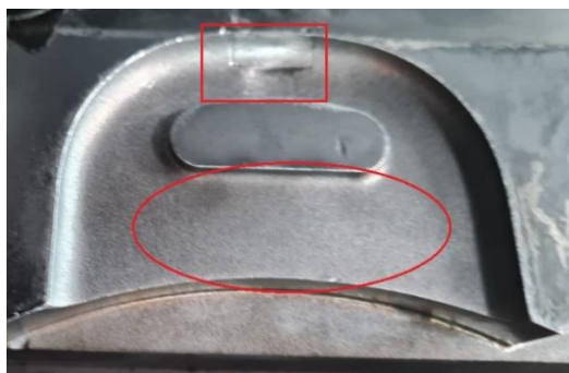
Figura 8 – Cavidade com desgastes superficiais
